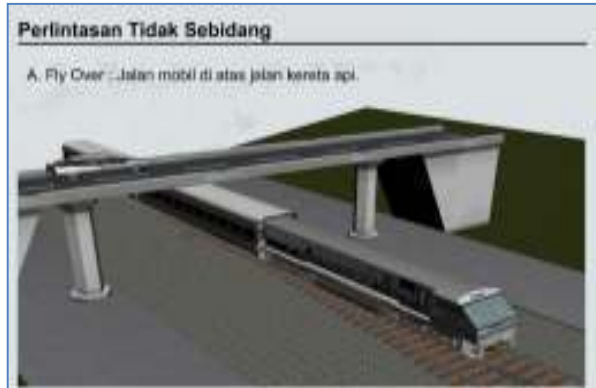
Gambar 4.5 : Perlindungan tak sebidang jenis Fly Over
